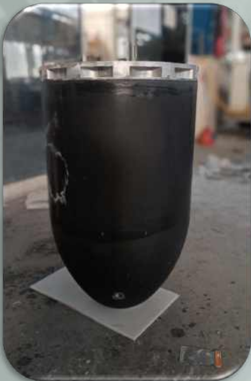
ساخت ملخ کامپوزیتی یکپارچه هواپیما به روش Bladder Molding
