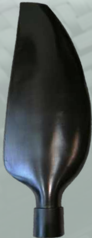
ساخت ملخ کامپوزیتی یکپارچه هواپیما به روش Bladder Molding
