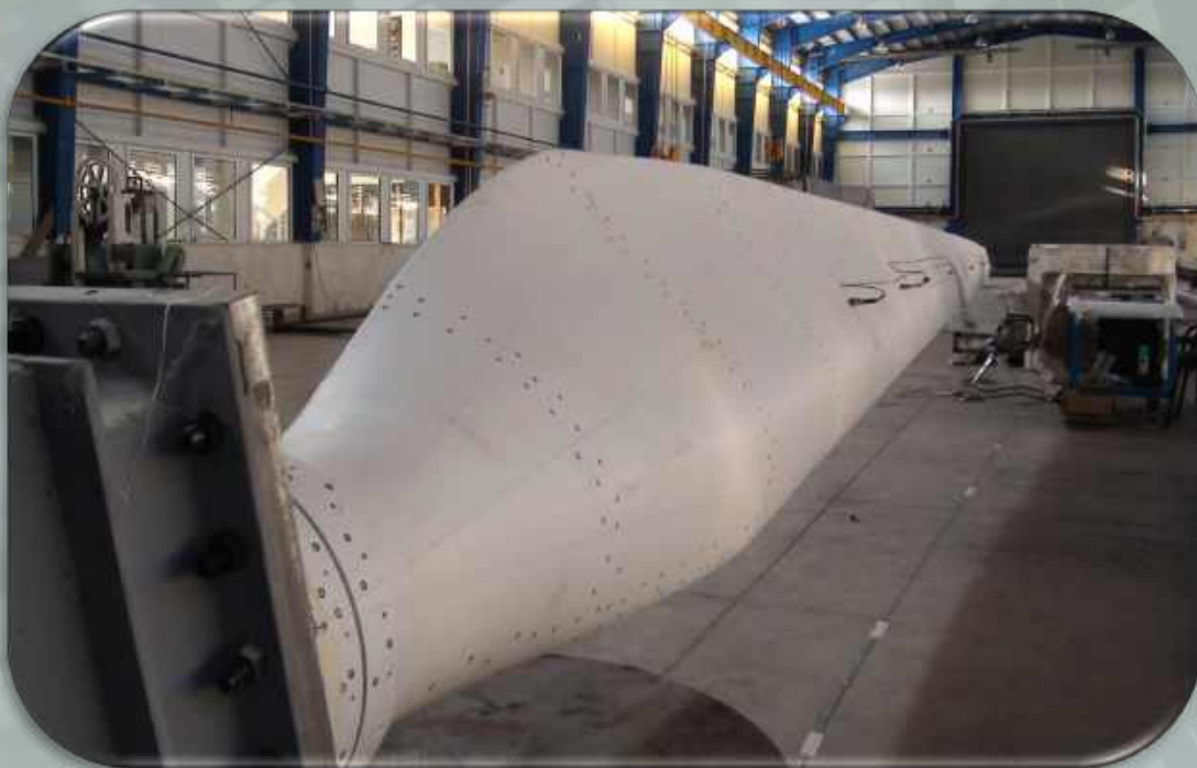
ساخت پره کامپوزیتی ۱۰۰ کیلووات روش VIP
