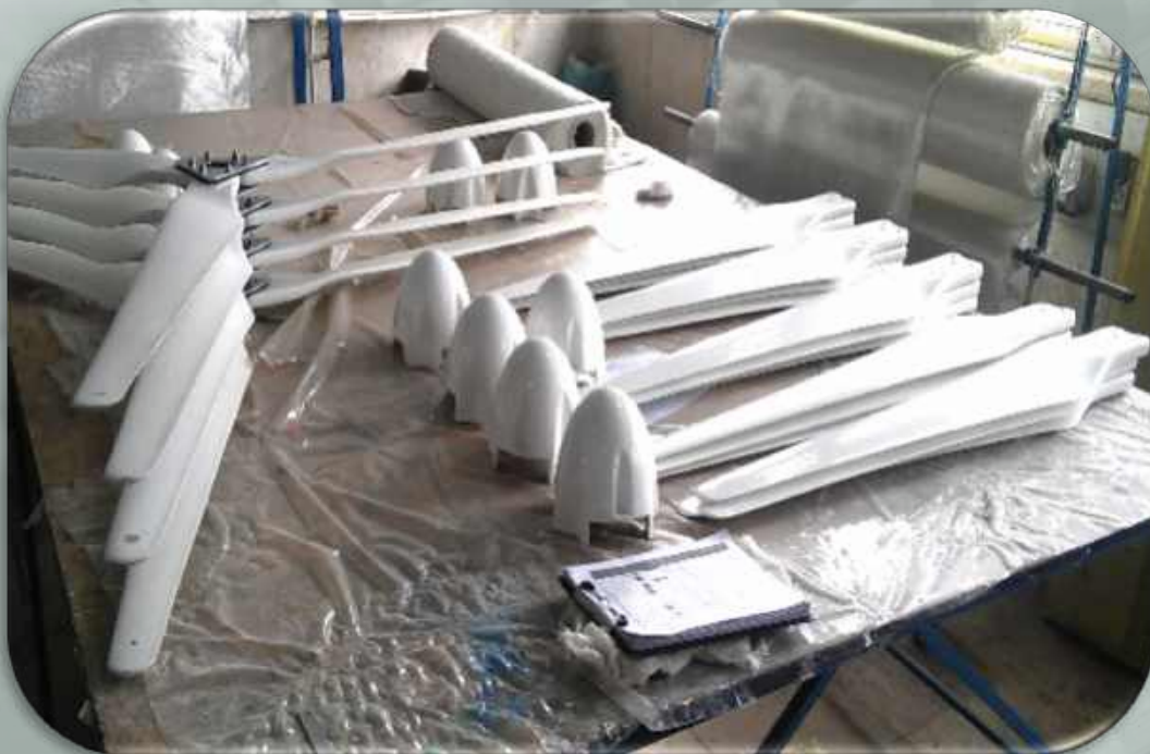
ساخت پره کامپوزیتی ۱ و ۳ کیلووات به روش VIP
